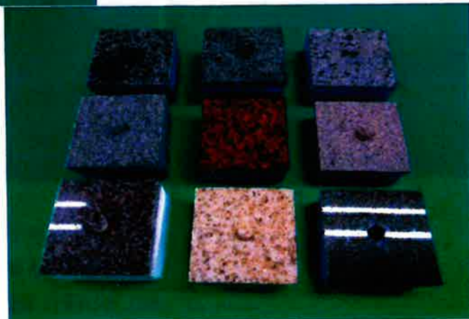
足場つなぎ跡補修象嵌を外した状態
